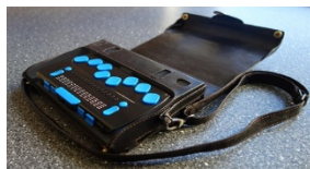
Портативный компьютер с вводом/выводом шрифтом Брайля и синтезатором речи «ElBraille- W14J G1
