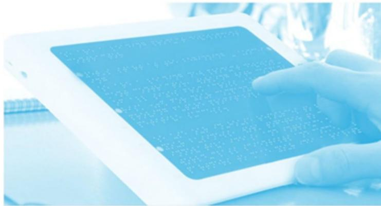
**Рекомендуемый комплект оснащения стационарного рабочего места для незрячего или слабовидящего пользователя:** персональный компьютер с большим монитором (19-24"), с программой экранного доступа JAWS, программой экранного увеличения MAGic и дисплеем, использующим систему Брайля (рельефно-точечного шрифта).
